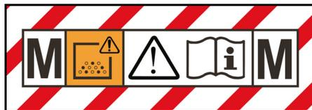
Apparatet er beregnet til opsugning af støv indtil støvklasse M.
