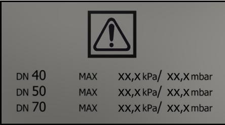
Etiket, kullanılan emme hortumu kesitine göre maksimum negatif basınç değerlerini gösterir. Gerçek değer manometreden okunabilir. Bu cihaz için geçerli olan değerler için bkz. Bölüm *Minimum hacimsel akışı okuyun*. Bu değer altına düşülürse filtre temizlenmeli (bkz. Bölüm *Filtrenin temizlenmesi*) veya değiştirilmelidir (bkz. Bölüm *Filtreyi değiştirme*). Farklı emme hortumu kesitleri, aksesuarların farklı bağlantı kesitlerine uyum sağlamasını mümkün kılar.
