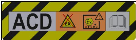
Устройство подходит для всасывания воспламеняющейся пыли при установке вне зоны 22.
