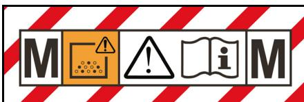
Cihaz M toz sınıfına kadar olan tozları vakumlamak için uygundur.
