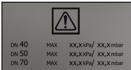
На наклейці зазначені значення макс. розрідження відносно поперечного перерізу використовуваного всмоктувального шланга. Поточне
