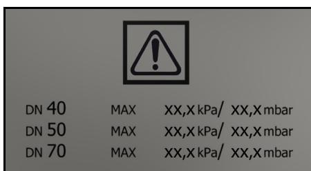
La pegatina muestra los valores de la baja presión máxima en relación con la sección transversal de la manguera utilizada. El va-
