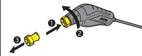
**2** 安装泡沫喷壶：将枪口向内按压并旋转 90°
