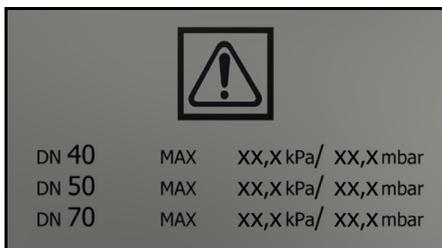
Na naklejce podana jest maks. wartość podciśnienia w odniesieniu do stosowanego przekroju węża ssącego. Aktualną wartość można odczytać na manometrze. Wartości obowiązujące w przypadku tego urządzenia, patrz rozdział *Odczyt minimalnego przepływu objętościowego*. Jeśli ta wartość nie zostanie osiągnięta, należy wyczyścić filtr (patrz rozdział *Czyszczenie filtra*) lub go wymienić (patrz rozdział *Wymiana filtra*). Różne przekroje węża
