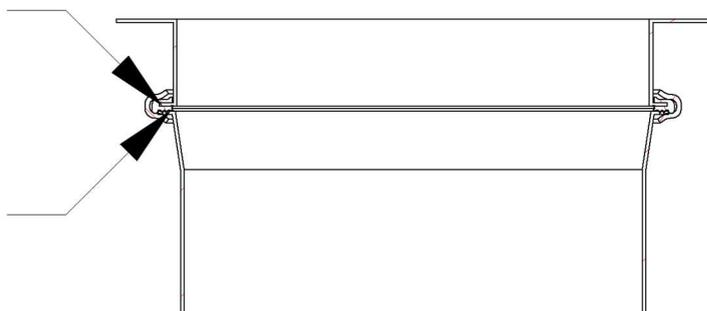
Lors de l'utilisation de joints EPDM, la peinture doit être retirée de l'intérieur des fusées éclairantes pour garantir une mise à la terre continue.
