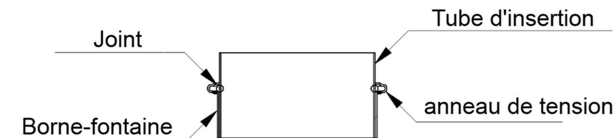
Le joint annulaire conducteur sert de connexion entre le tube d'insertion et le tube standard.
