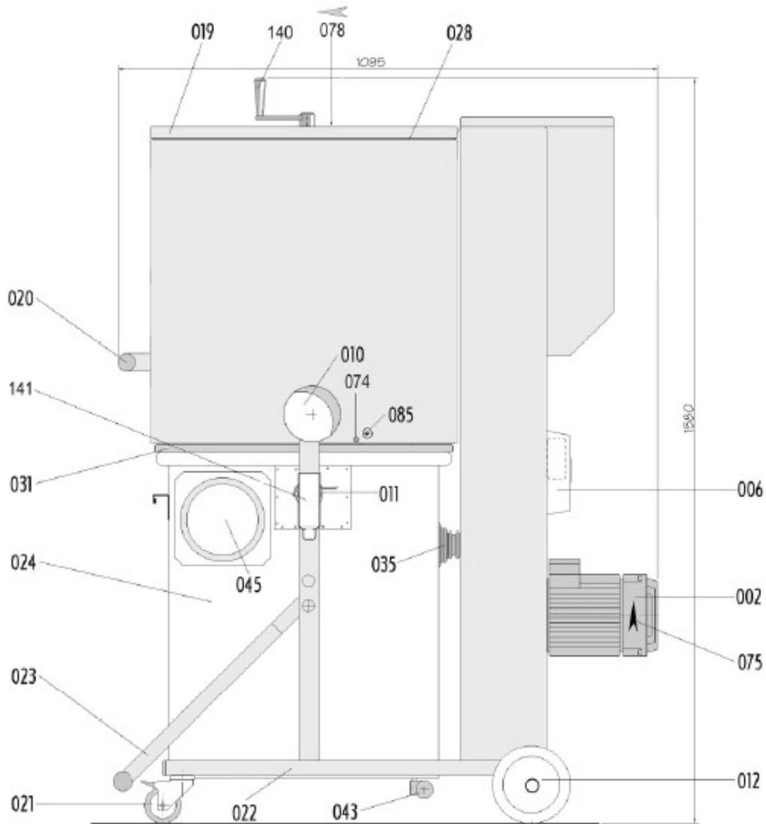
**Nomenclatures des pièces de rechange****12.1.2 Vue de côté « Section de la tubulure d'aspiration »**
