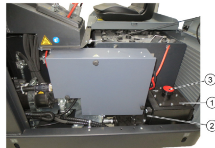
1 Depósito do óleo hidráulico
