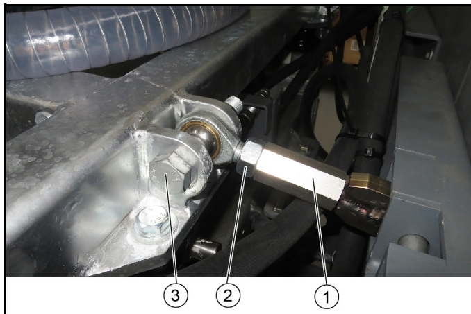
Obrázok: Upevnenie horných riadiacich tyčí v prípade platformy D a E
