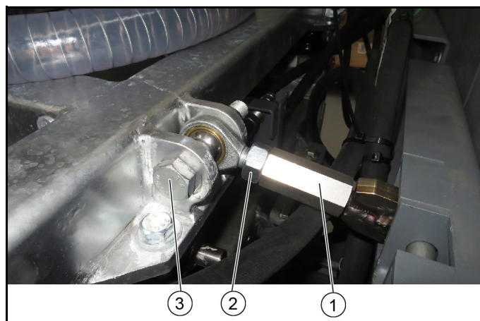
Рисунок: Кріплення центральної тяги на платформі D і E
