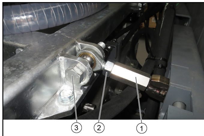
Εικόνα: Στερέωση άνω βραχίονα πλατφόρμας D και E
