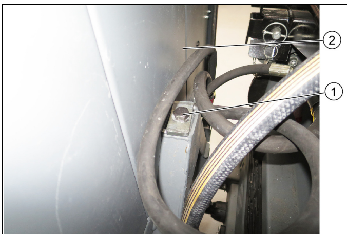
Figura: Fijación del brazo superior de la plataforma D y E
