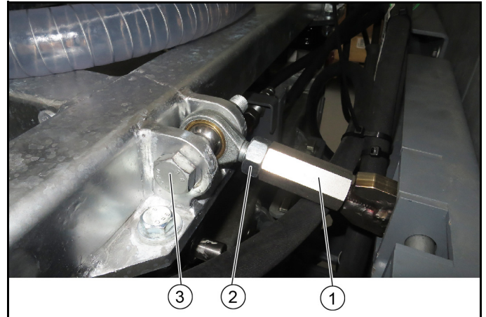
Abbildung: Oberlenkerbefestigung Plattform D und E
