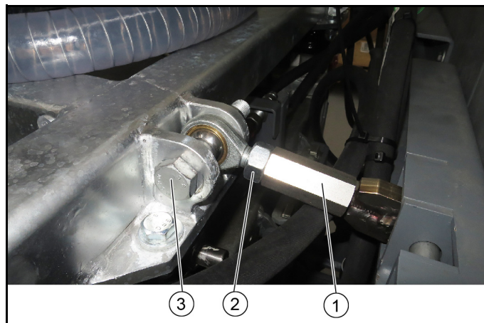
Bild: Styrarmsfastsättning plattform D och E
