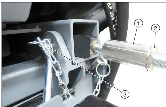
Rysunek: Mocowanie górnego elementu kierującego na platformie C
