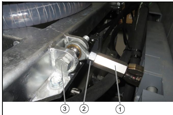
Figura: Fissaggio del braccio superiore piattaforma D ed E
