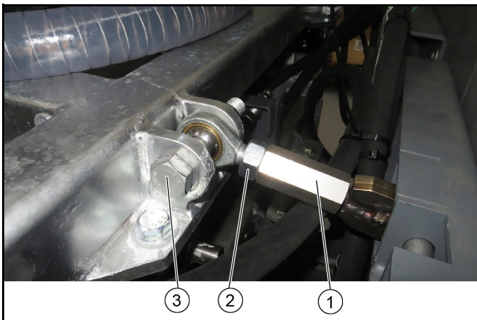
Фигура: Закрепване на горния съединителен лост платформа D и E
