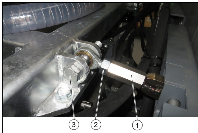
Figur: Topstangsfastgørelse platform D og E
