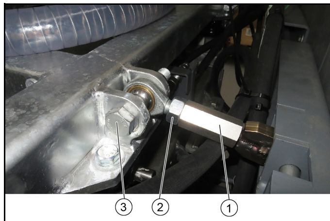
Slika: Pritrditev zgornjega kraka platforma D in E
