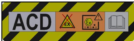
Apparatet er beregnet til opugning af brandbart støv, opstilling uden for zone 22.
