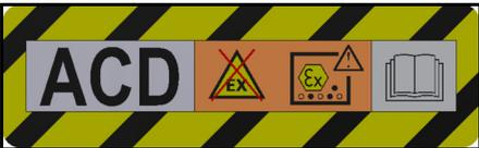
Das Gerät ist zum Saugen von brennbaren Stäuben, Aufstellung außerhalb Zone 22 geeignet.
