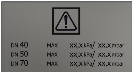
Na nálepke sú uvedené hodnoty pre max. podtlak vo vzťahu k použitému prierezu nasávacej hadice. Aktuálnu hodnotu môžete odčítať na manometri. Hodnoty platné pre tento prístroj sú uvedené v kapitole *Odčítanie minimálneho objemového prietoku*. Pri
