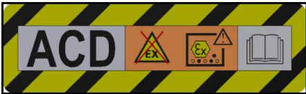
Laite soveltuu tulenarkojen pölyjen imurointiin, asennus vyöhykkeen 22 ulkopuolelle.
