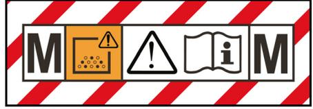
Cihaz M toz sınıfına kadar olan tozları vakumlamak için uygundur.
